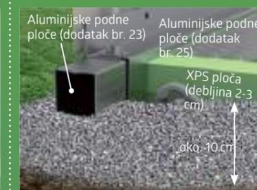
**Aluminijski podni okvir** možete postaviti u sloj šljunka i time osigurati ostavu za alat od oluje i na neravnom zemljištu. (podne kopče su uključene u opseg dostave). **Aluminijske podne ploče** služe kao funkcionalan pod i podstavljene su XPS pločama od tvrde pjene koje nisu uključene u isporuku).
