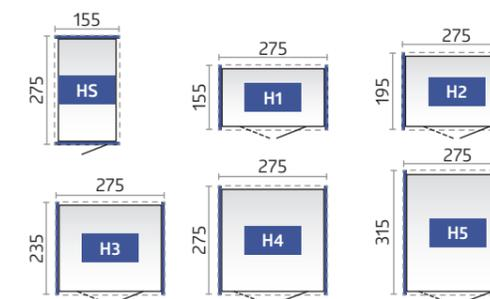
**Savjet:** Od H2 veličine nadalje možete prema vlastitim potrebama rotirati HighLine® i klasična vrata se mogu postaviti na bilo koji zid. Od dimenzije H4 nadalje, postavljanje dvokrilnih vrata na bočnoj strani je također moguće.
